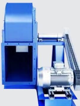
Simile all'esecuzione 1 per accoppiamento a cinghie, con il motore e ventilatore montati sullo stesso basamento. Massima temperatura di funzionamento in esecuzione standard: 60°C. Con ventolina di raffreddamento: 300°C.
