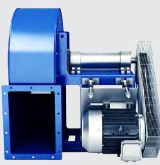
Simile all'esecuzione 1 per accoppiamento a cinghie, con il motore sostenuto sul fianco della sedia. Massima temperatura di funzionamento in esecuzione standard: 60°C. Con ventolina di raffreddamento: 300°C.
