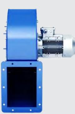
Accoppiamento diretto. Girante montata direttamente sull'albero motore. Motore flangiato e ventilatore senza sedia. Massima temperatura di funzionamento in esecuzione standard: 60°C. In esecuzione speciale: 150°C.
